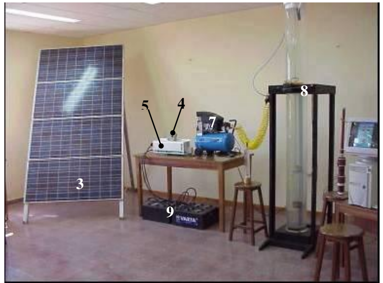
Figura 4. Sistema completo para la extracción de agua mediante energía solar.
